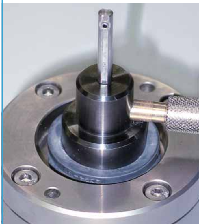
Сопло-измерительный дорн с «плавающим» расположением
