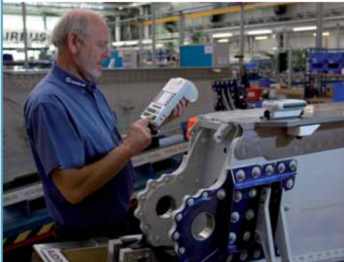
Измерение шероховатости на выдвигающих элементах (предприятие Airbus)
