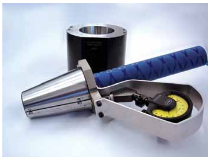
Коническое сопло-измерительное кольцо с коническим приспособлением
