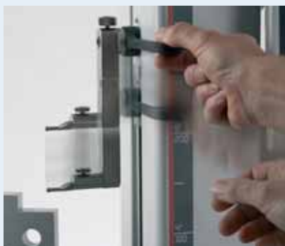
Рис. 1. Переместите измерительную каретку в направлении измеряемого объекта.
