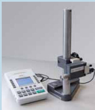
Пример: измерение с использованием устройства установки по высоте
