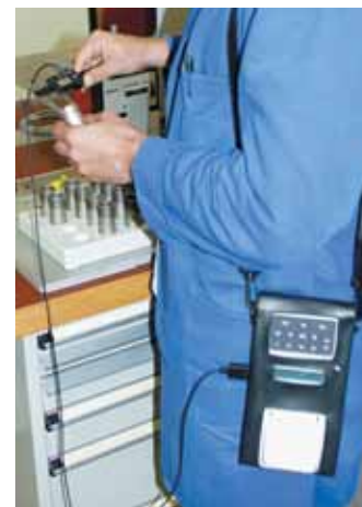
На снимке показано использование статистического принтера в сумке для транспортировки
