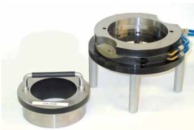
Пневматическое сопло-измерительное кольцо
