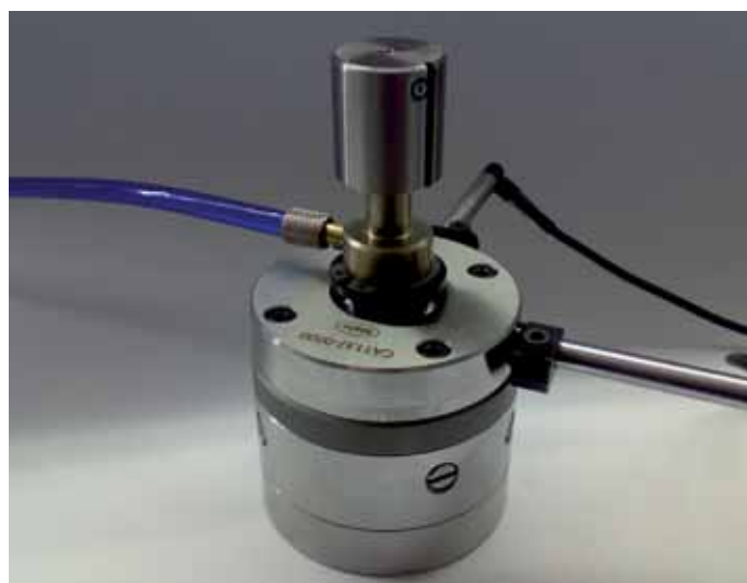
«Плавающее» сопло-измерительный дорн для определения диаметра и положения
