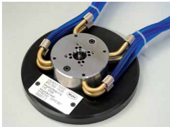
Коническое сопло-измерительное кольцо с парными измерителями в 2-х уровнях для проверки до 4-х \varnothing , 2-х углов конуса, 2-х уклонов конуса
