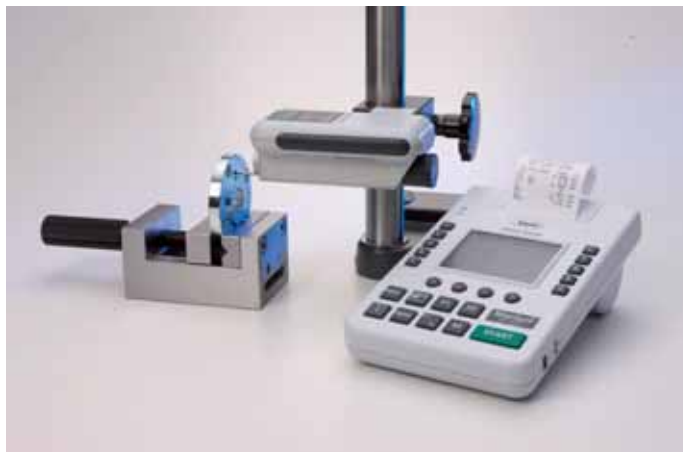
Измерение шероховатости на несущей поверхности (предприятие Airbus)
