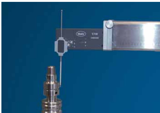
T7W со щупом для измерения шероховатости
