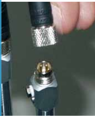
Возможность расстыковки кабеля и щупа.
