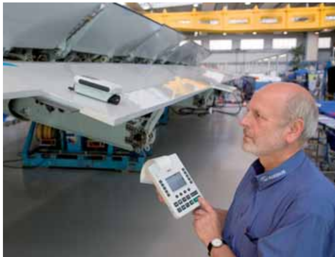
Измерение шероховатости на несущей поверхности (предприятие Airbus)
