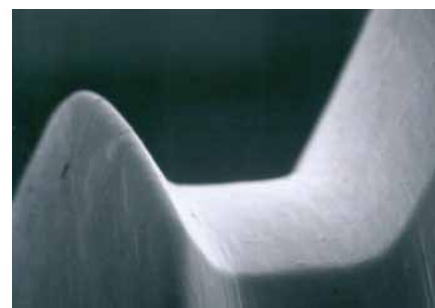
Оптимизированная поверхность бесстружечного метчика Profile фирмы Gühring
